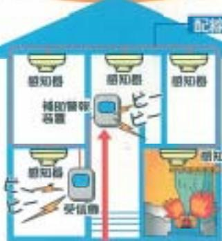
従来の消防用設備の1つである自動火災報知設備の感知器（煙式）と受信機（中継器が必要な場合もある。）で配線された警報設備（住宅用自動火災報知設備）を設置することもできます。
