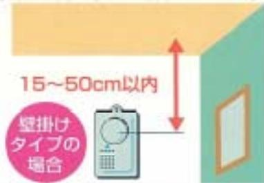
住宅用火災警報器は、機器に付属されているビスなどで、住宅内の天井若しくは壁面に取り付けます。
